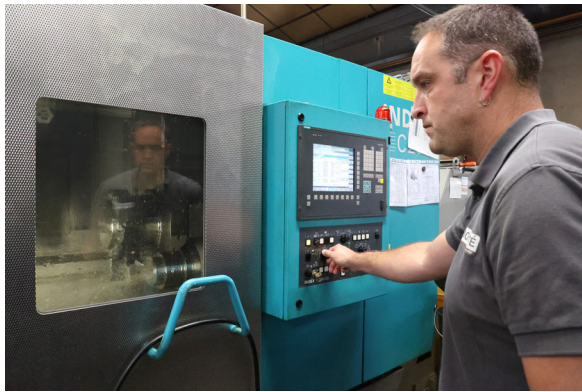
Machine-outil à commande numérique à poupée fixe (Index C200).
