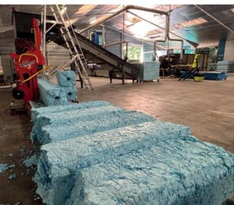
**REPAN** est une unité de déconstruction de panneaux sandwich. Le service consiste à séparer les différents composants comme les parements en aluminium et le polystyrène extrudé (XPS) de l'isolant. Les matières sont ensuite valorisées dans les filières de recyclage dédiées.
