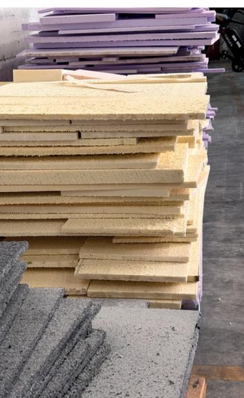
**REPAN** ne se limite pas à trier, séparer et recycler. L'unité constitue aussi un laboratoire industriel de la réutilisation. Parmi les projets les plus structurants, **REPAN** s'attache à transformer l'isolant extrait des panneaux sandwich en une matière recomposée à forte valeur ajoutée. Poncé, nettoyé, puis remis en forme, ce matériau entre aujourd'hui dans une phase de reconnaissance officielle avec une procédure de certification ACERMI en cours.
