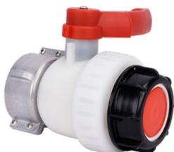
Assurant un réglage du débit, une vanne à écrou mobile s'installe directement en sortie de cuve. L'écrou mobile présent sur la vanne offre une installation bien droite pour limiter tout risque de fuite. Dotée d'un système à bille, elle est plus résistante aux ouvertures/fermetures quotidiennes en comparaison à l'opercule vendu par défaut avec la cuve.
