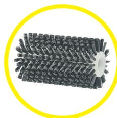
Pour des impuretés plus tenaces telles que les lichens, une brosse PRO avec des poils en acier revêtus de laiton peut être installée sur le **MultiBrush**. Cette brosse - Ø100 mm / largeur 165 mm - est particulièrement adaptée aux surfaces robustes comme les dalles gravillonnées et n'est pas recommandée pour les pierres naturelles, pierres synthétiques polies, poncées ou vitrifiées.
