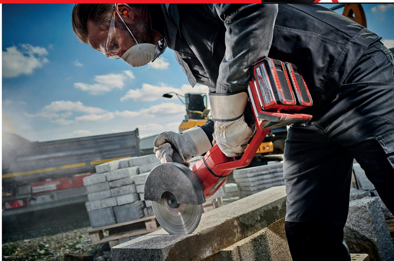
Spécialiste de l'outillage électroportatif filaire et sur batterie, EINHELL présente sa nouvelle meuleuse d'angle sans fil AXXIO 36/230 Q. La machine vient enrichir la gamme "Professional" du fabricant allemand pour répondre aux attentes des bricoleurs expérimentés et des artisans. Doté d'un mandrin auto-serrant, de deux poignées et d'une fonction anti-vibration, l'outil autorise une forte profondeur de coupe, jusqu'à 70 mm permettant ainsi d'adapter son utilisation à tous types de besoins.
