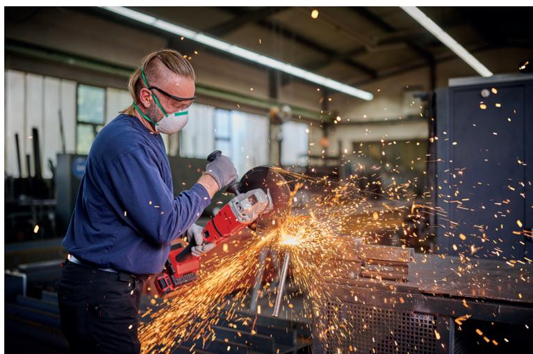
La **meuleuse sans fil AXXIO 36/230 Q** fonctionne à l'aide de la technologie TWIN PACK qui regroupe deux batteries 18V, compatibles avec la gamme Power X-Change.
