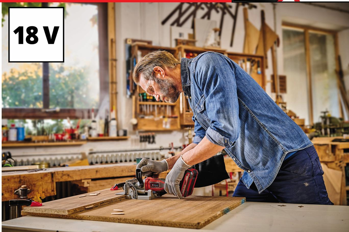
Spécialiste de l'outillage électroportatif filaire et sur batterie, EINHELL présente sa nouvelle fraiseuse à lamelles sans fil TE-BJ 18 Li-Solo. La machine vient enrichir la gamme « Expert » du fabricant allemand pour répondre aux attentes des bricoleurs chevronnés et des artisans menuisiers. Elle convient aux chevilles de type biscuit standard jusqu'au type 20.
