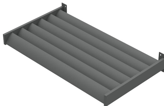
La version **KOMETE** Standard propose des lames disposant d'un profil en demie aile d'avion fixée à 45° sur le cadre et une dimension unique de 1 400 x 800 mm (Largeur x Avancée) avec un poids d'à peine 13 kg. Quant à la version **KOMETE** Premium, celle-ci est proposée avec des lames rectangulaires de section 120x25 mm, pouvant se fixer, au choix, à 45° ou à 90° et en deux dimensions de L 1 400 x A 1 000 mm ou L 2 800 x A 1 000 mm pour un poids respectif de 28,5 kg et de 51 kg.
