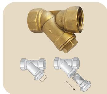
Destiné aux pompes de surface, le filtre anti-sable en laiton de **BOUTTÉ** est équipé d'une filtration en inox démontable pour assurer son entretien. D'une grande résistance, l'accessoire affiche une excellente tenue à la pression jusqu'à 20 bars et à une température de 80°C maximum. Filetages femelles disponibles : 20x27, 26x34, 33x42 mm.
