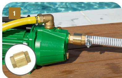
**Clapet anti-retour** s'utilisant dans toutes les positions. Tenue en pression : 16 bars. Résistance à des températures de -20 à +110°C. Filetages femelles disponibles : 15x21, 20x27, 26x34, 33x42, 40x49, 50x60.
