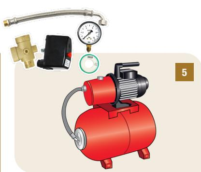
**Kit complet de raccordement de réservoir** comprenant un pressostat (fonctionnement : 16 ampères) disposant d'une amplitude de 1 bar minimum à 5 bars maximum et réglé en usine de 1,4 à 2,8 bars, un raccord 5 voies, un manomètre, un flexible coudé et un rouleau de Téflon.
