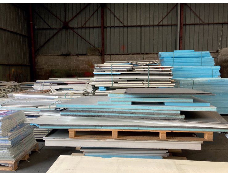
Panneaux sandwich en attente de traitement en amont de la ligne de déconstruction REPAN, unité autonome de recyclage d'ISOSTA.
