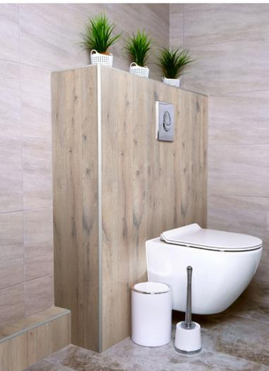
Disponible dès 2022, Roth a développé un panneau spécifique à l'habillage des bâtis-supports. Le nouveau panneau Vipanel de Roth apporte un réel gain de temps sur les chantiers. Pour cela, il est pré-percé d'usine (évacuation Ø 115 mm, alimentation chasse d'eau Ø 72 mm, et filetage fixation cuvette Ø 40 avec entraxe de 180 mm). Le panneau Vipanel est compatible avec les grandes marques de bâtis-supports.
