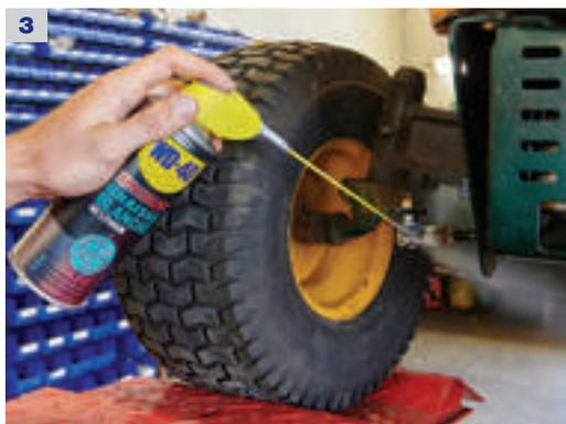
3 La vaporisation de la Graisse Blanche au Lithium WD-40 SPECIALIST assure la lubrification des rotules et des biellettes de direction.
