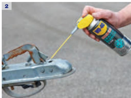
2 Idéale pour toutes les pièces en mouvement, la Graisse Blanche au Lithium WD-40 SPECIALIST lubrifie et protège les pièces mobiles du crochet d'attelage.
