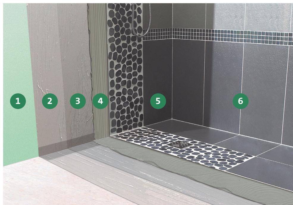
**Système d'Etanchéité Liquide (SEL)**
