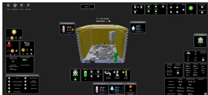
Interface de la GTB d'une Box Multipack gérant le dispositif de rafraîchissement adiabatique "Adiabox" produit par Bluetek, marque du groupe Adexsi
